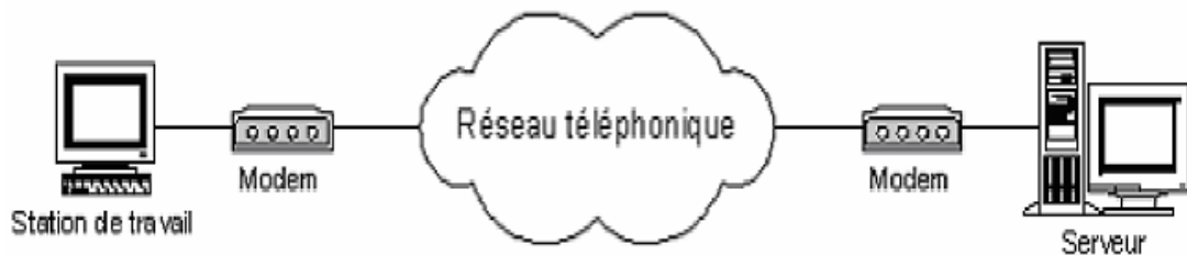
Figure 29: Communication entre deux ordinateurs par le réseau téléphonique à travers le modem
